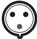
2P/3W 32 A 250 V Position d'horloge à 6h
